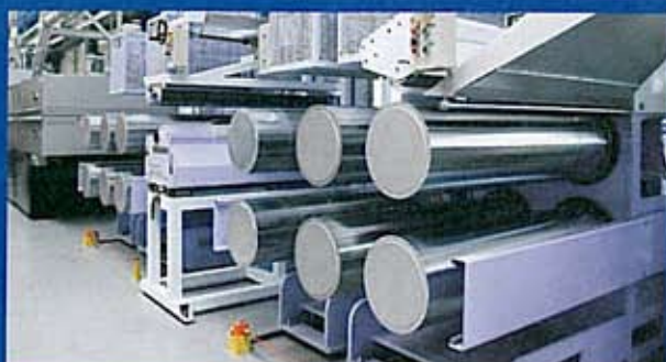
Monofil-Bändchen-Anlage mit beheizbaren Galetten
