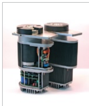
Servoeinheit mit interner Elektronik
